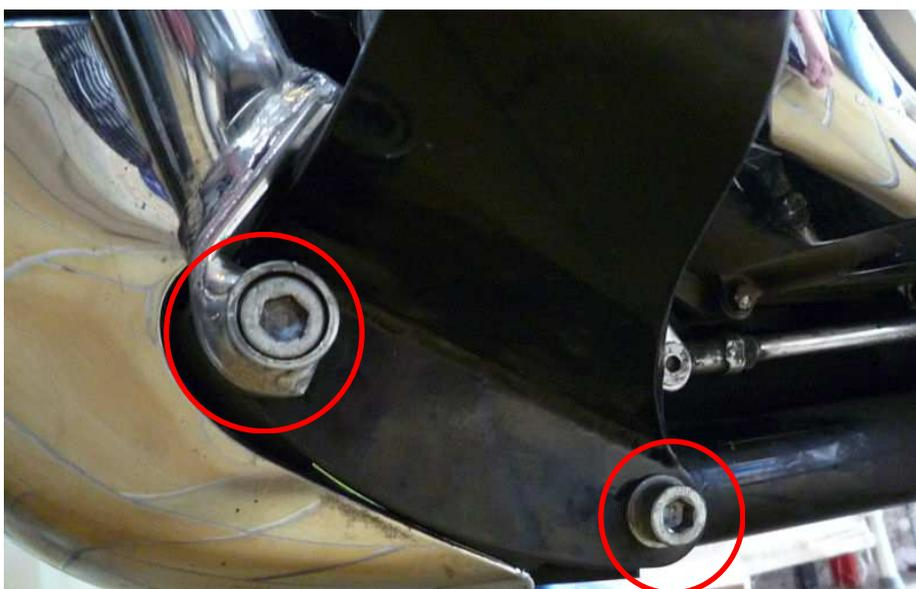
Im nächsten Arbeitsgang demontieren wir die Fußrastenhalteplatten links und rechts.
