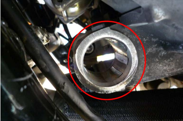
Jetzt reinigen wir die beiden Aufnahmebuchsen von Schmutz und Gummirückständen bevor wir die neuen Gummilager einbauen!
