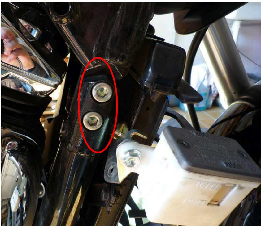
Und als letztes demontieren wir noch die 2 Schrauben rechts oben am Rahmen (die von dem Bremsflüssigkeitsbehälter verdeckt waren).
