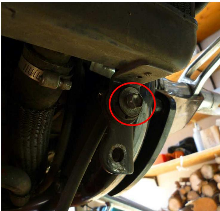
Auf diesem Bild sehen wir die untere Kühlerbefestigung. In diesem Bereich (dahinter) sind auch die linken Rahmenbefestigungsschrauben zu finden.
